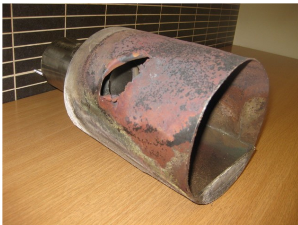
Foto 1 Vigane põlemiskamber ja deformeerunud põlemisrest
