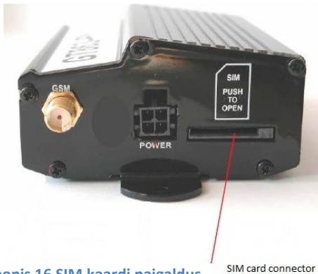
Joonis 16 SIM kaardi paigaldus
